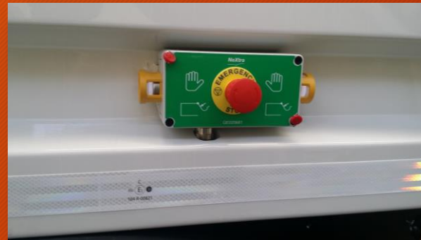
Comandi per l'azionamento della paratia e lo scarico Control panels for the movement of the ejection plate
