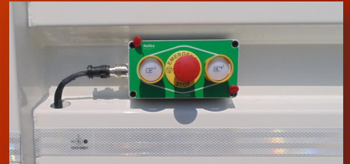
Comandi per l'azionamento della paratia e lo scarico Control panels for the movement of the ejection plate
